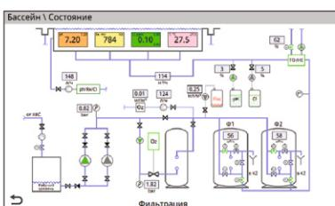
Схематическое отображение текущего состояния системы водоподготовки, характере протекающих в ней процессов, в том числе связанных с нарушением технологических режимов и авариями.
